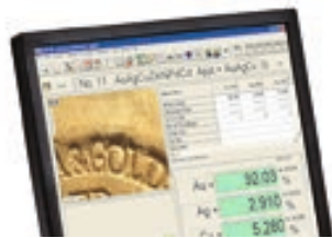
Video görüntüsü, ölçüm noktasını tam olarak görüntüler
